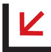
Ten róg szyby zawsze na dole - dotyczy montażu szyby w ramie oraz transportu i przechowywania.
