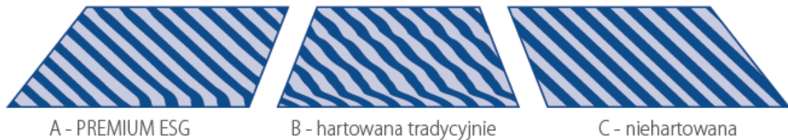
Rys. 26 Porównanie szyb hartowanych tradycyjnie i z wykorzystaniem linii PREMIUM ESG
