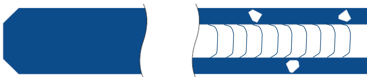
Rys. 2 Schemat zatępionej krawędzi szkła
