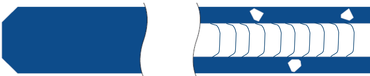
Rys. 6 Zebrane obrzeże (z błyszczącymi obszarami) – krawędź zatępiona
