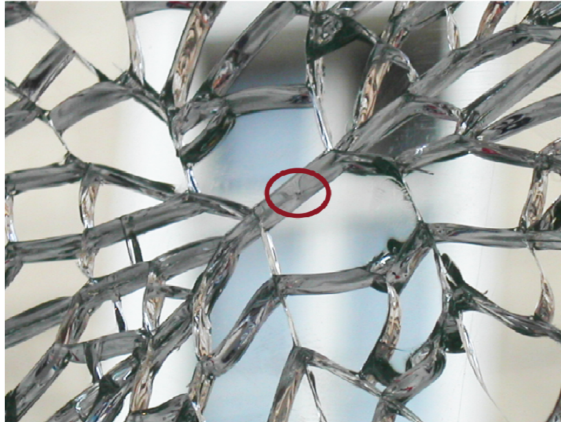
Rys. 30. Przykład samoistnego pęknięcia szyby w wyniku obecności siarczku niklu
