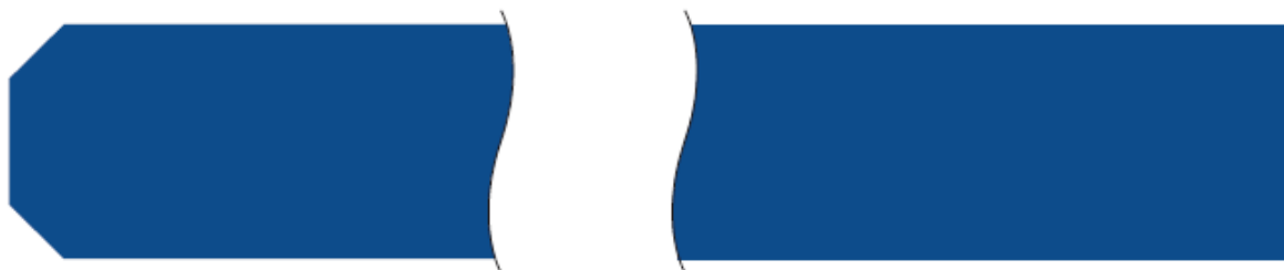
Rys. 8 Wygładzone zeszlifowane obrzeże (bez błyszczących obszarów) – krawędź szlifowana
