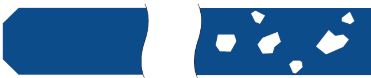
Rys. 7 Zeszlifowane obrzeże (z błyszczącymi obszarami) – krawędź zatępiona z wyrównanym czołem lub szlifowana
